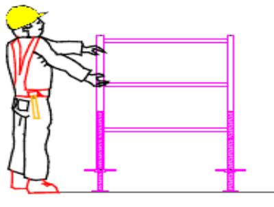
8-Pose et verrouillage de la diagonale laissée à portée de main
