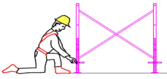
13-Pose des 2 lisses garde-corps à connecteurs intégrés
