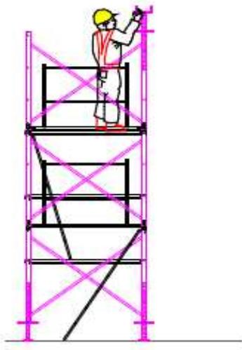
31-Réglage final à la cote du plan en utilisant uniquement les vérins de tête
