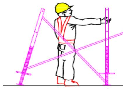
10-Accouplement des diagonales avec le cadre et les verrouiller.
