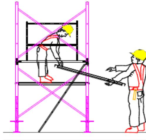
**22-Pose des 2 lisses garde-corps à connecteurs intégrés**
